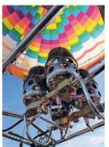
Die Brenner sorgen dafür, dass der Ballon in die Luft steigt. Foto: jvh
